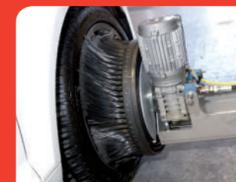
L'inversion de rotation et inclinaison de la brosse permet une propreté soignée des roues de différentes dimensions.
