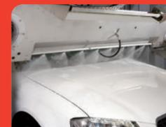
Supérieure avec suivi du profil du véhicule Haute pression sur lame basculante à trois positions pour une meilleure efficacité du nettoyage.
